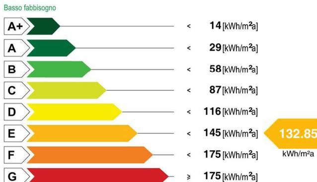
Valore limite del fabbisogno per la climatizzazione invernale: **78.85 [kWh/m²a]**
